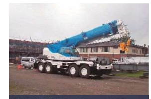
ラフタークレーン 70t
