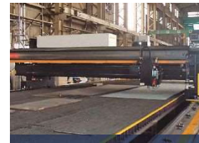
NCLレーザー切断機 出力6KW
